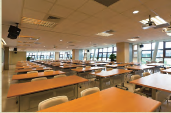
經濟部嘉義產業創新研發中心第一期新建工程：會議室地板採用亞麻仁油環保地毯。牆面採用綠建材水性水泥漆，提供更健康的室內環境。
