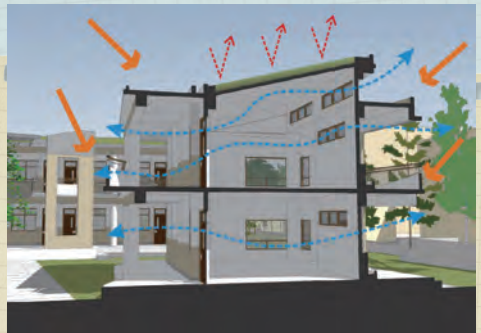
臺中市北屯區大坑國民小學老舊校舍整建工程：教室採通風採光設計。
